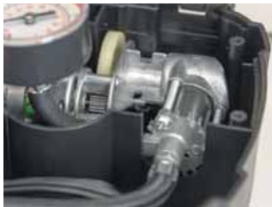
Цельнометаллический поршневой насос в пластиковом корпусе
